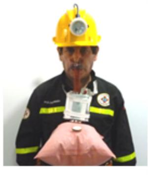
El autorrespirador de oxígeno **ZH 30** es un aparato respiratorio, que puede generar oxígeno aislante con un estilo de circulación del circuito cerrado por medio de una reacción química, Se destina para uso en minería o con la existencia de ambientes nocivos
