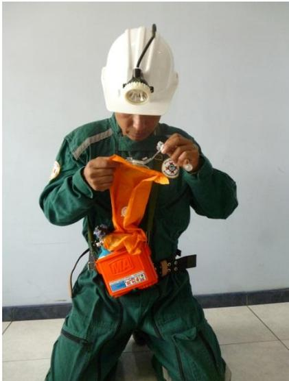
5. Retire el tapón de la boquilla y de inmediato inserte la boquilla entre los dientes, agarre la boquilla con los dientes y comprima con los labios.
