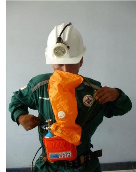
8. Ajuste la correa del cuello. El ajuste correcto se puede comprobar al elevar su cabeza para mirar hacia arriba. Si usted siente un tirón en la boquilla, la unidad es demasiado baja en el pecho.
