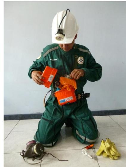
3. Retire la cubierta superior. Queda al descubierto: La boquilla, la bolsa de respiración, la válvula de la botella de oxígeno y las gafas.
