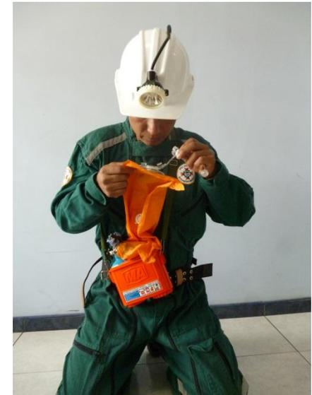
4. Despliegue la bolsa de aire. Evite la torsión
