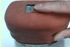
5. Para la eliminación del autorescate usado y obsoleto, se requiere abrir la cubierta, desmontar el dispositivo de arranque y luego lavar la bombona con el fin de hacer que el agente generador de oxígeno quede inocuo para la salud. Está prohibido al personal de rescate botar a la basura el auto rescate obsoleto; para evitar accidentes de incendio por el oxígeno producido por la bombona.
