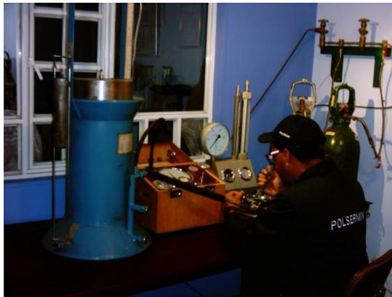
Laboratorio de prueba para simulación de condiciones de respiración. Máquina respiratoria EN13794 (En polsermin). Se deben tener en cuenta los ajustes por influencia de la altura s.n.m. presión atmosférica y temperatura para los equipos de respiración. Se hacen las correcciones para los actuales equipos de salvamento?
